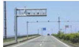
頭上から狙うのはカメラとストロボだけ。本体の約50m手前で速度を測定し約40m手前で撮影します。(写真は直後にNもあり!)
